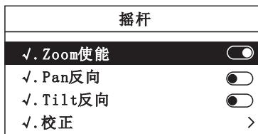
Zoom使能：打开后，旋转摇杆可对摄像机变倍进行控制
