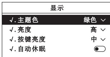
主题色：修改键盘主题显示颜色（修改后断电重启生效）
