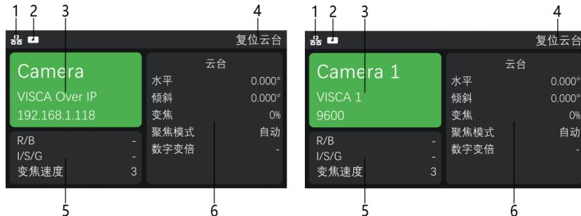
1、网络连接指示图标出现 “”，表示网络已连接；
